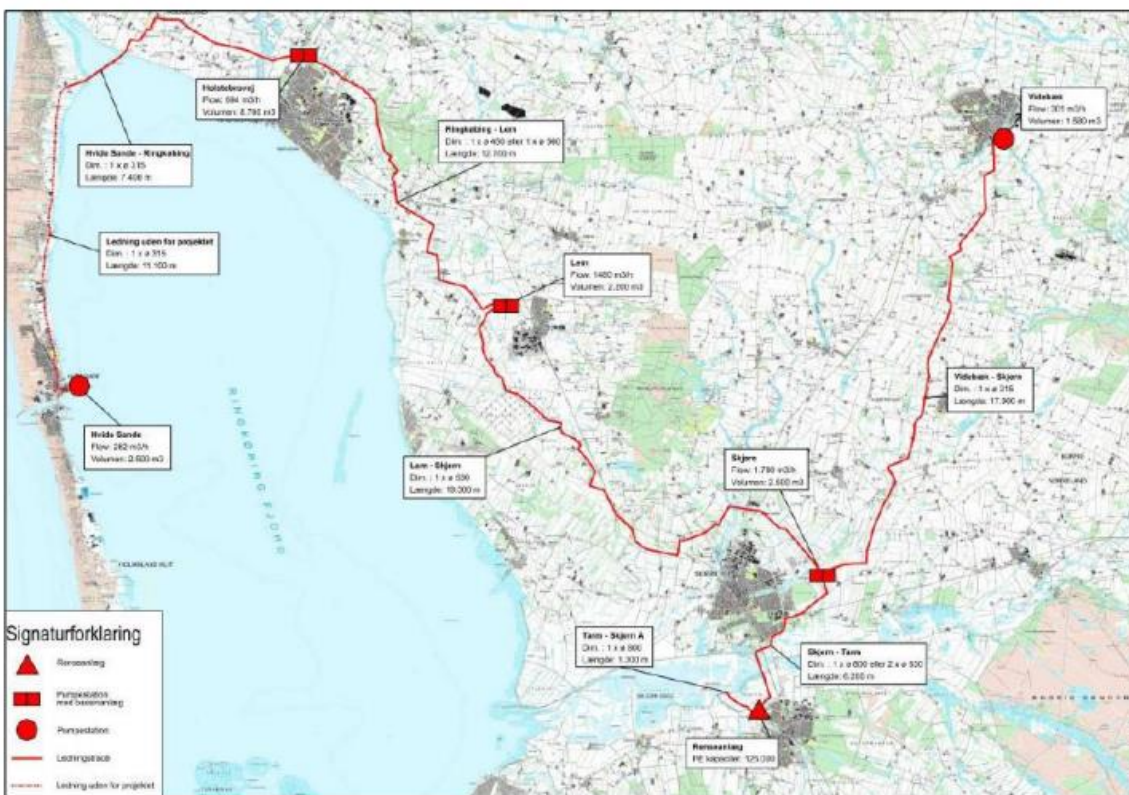
Figur 1.: Oversigtskort, der viser den fremtidige struktur for rensesanlæg i Ringkøbing-Skjern Kommune ved centralisering på et udbygget Tarm Renseanlæg med nye spildevandsledninger, pumpestationer m.m.
